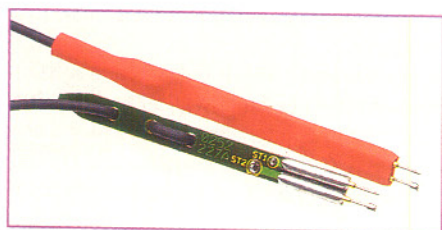
Bild 5: Spezial-Messleitungen mit federnd gelagerten Messspitzen.
