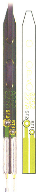
Ansicht einer fertig bestückten Messspitze des RIM 1000 mit zugehörigem Bestückungsplan
