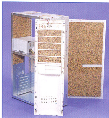
Bild 1: Eliminiert wirkungsvoll Körperschall - voll gedämmtes PC-Gehäuse
