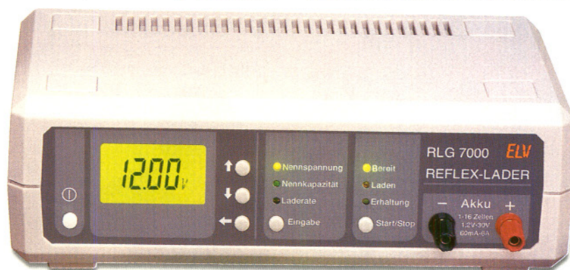
Bild 4: Reflexlader, hier der RLG 7000 von ELV, laden moderne Akkus blitzschnell.
