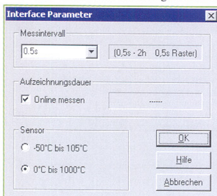
Bild 7: Dialogbox zum Einstellen von wichtigen Interface-Parametern
